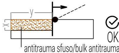
In caso di cordolo in Robinia non uniforme mantenerlo esternamente all'area di impatto/In case of non-uniform Robinia curb keep it outside the impact area.
