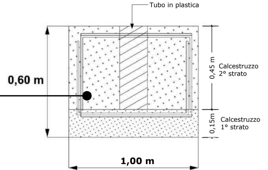
**Costruzione della fondazione con rete di rinforzo in acciaio**
