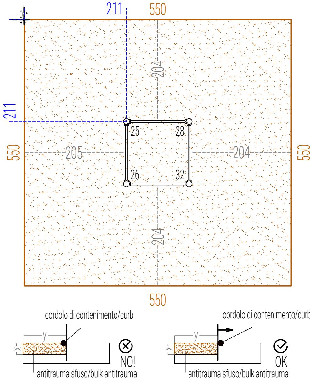
In caso di cordolo in Robinia non uniforme mantenerlo esternamente all'area di impatto/In case of non-uniform Robinia curb keep it outside the impact area.
