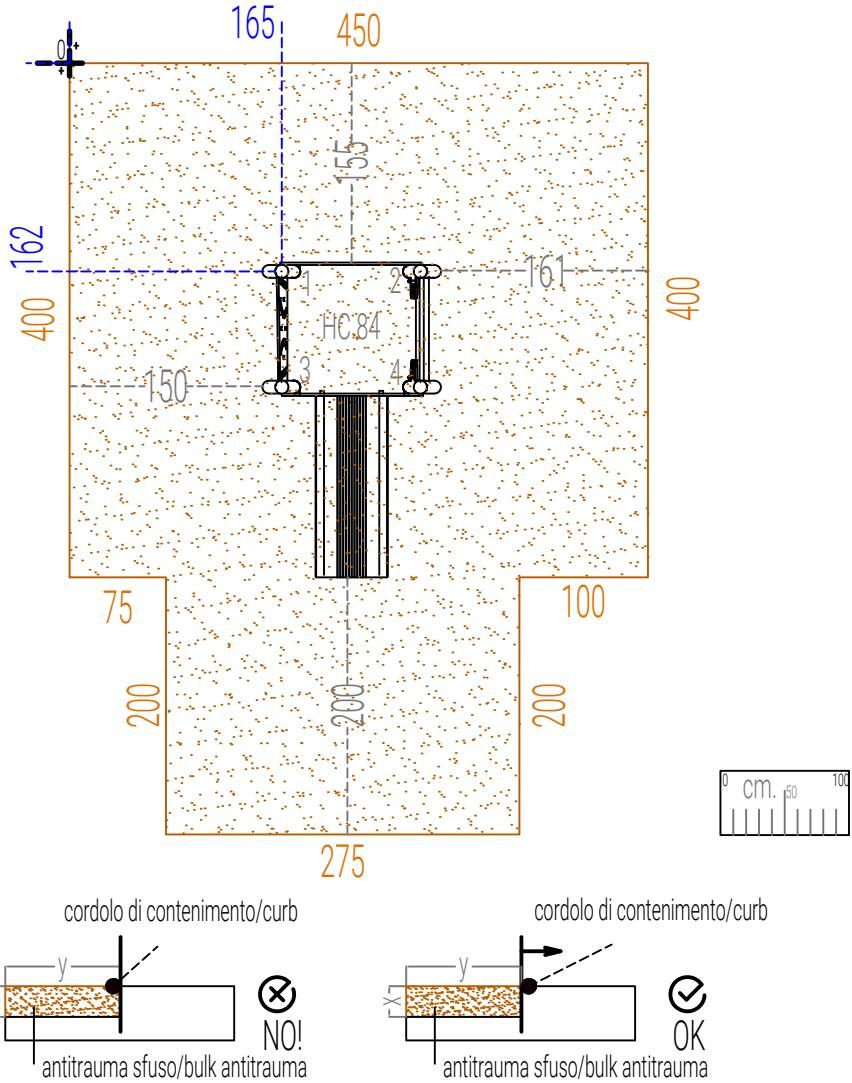
In caso di cordolo in Robinia non uniforme mantenerlo esternamente all'area di impatto/In case of non-uniform Robinia curb keep it outside the impact area.
