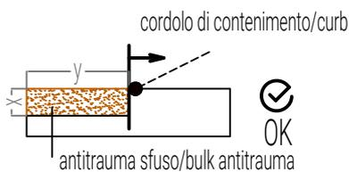
In caso di cordolo in Robinia non uniforme mantenerlo esternamente all'area di impatto/In case of non-uniform Robinia curb keep it outside the impact area.
