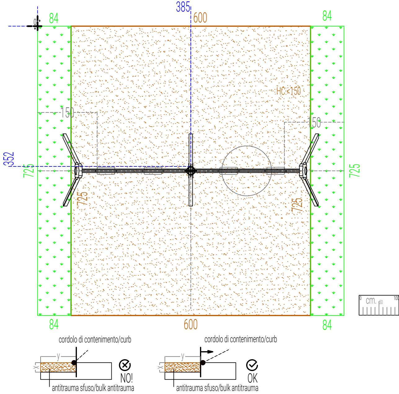
In caso di cordolo in Robinia non uniforme mantenerlo esternamente all'area di impatto/In case of non-uniform Robinia curb keep it outside the impact area.
