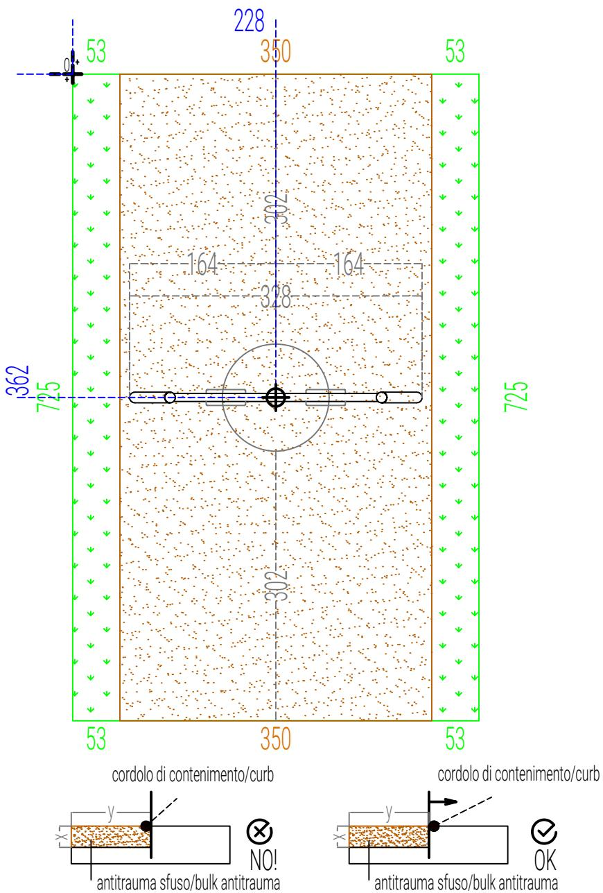
In caso di cordolo in Robinia non uniforme mantenerlo esternamente all'area di impatto/In case of non-uniform Robinia curb keep it outside the impact area.
