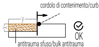
In caso di cordolo in Robinia non uniforme mantenerlo esternamente all'area di impatto/In case of non-uniform Robinia curb keep it outside the impact area.
