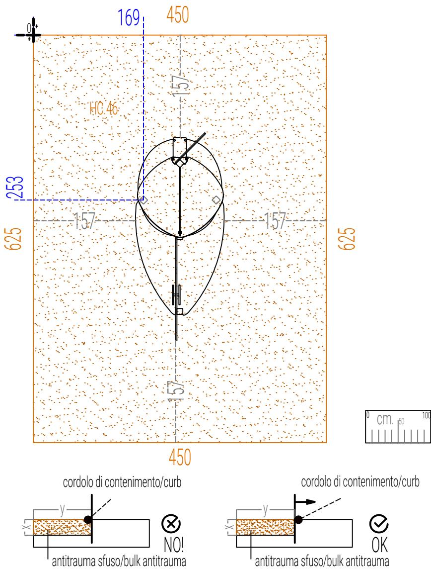
In caso di cordolo in Robinia non uniforme mantenerlo esternamente all'area di impatto/In case of non-uniform Robinia curb keep it outside the impact area.
