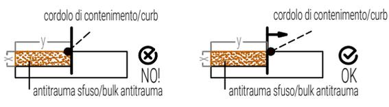
In caso di cordolo in Robinia non uniforme mantenerlo esternamente all'area di impatto/In case of non-uniform Robinia curb keep it outside the impact area.
