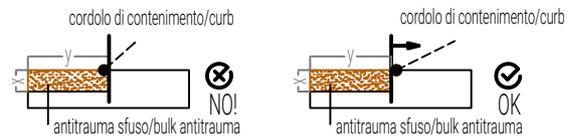
In caso di cordolo in Robinia non uniforme mantenerlo esternamente all'area di impatto/In case of non-uniform Robinia curb keep it outside the impact area.
