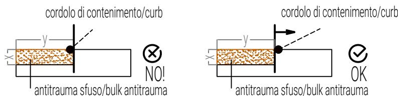
In caso di cordolo in Robinia non uniforme mantenerlo esternamente all'area di impatto/In case of non-uniform Robinia curb keep it outside the impact area.
